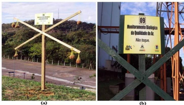
**Figura 1.** a) Modelo do suporte de uma estação de medição *moss bag*; (b) Modelo de identificação padrão de todas as estações *moss bag*.
